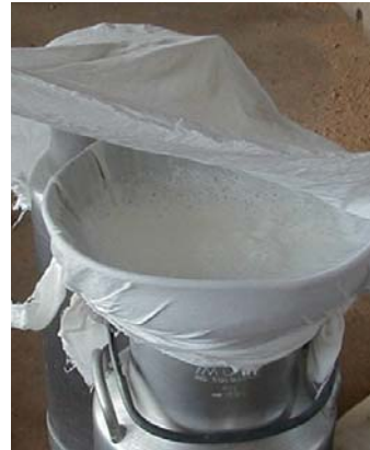
Filtro de aluminio con filtro de papel en el fondo mas una manta en su parte superior.
